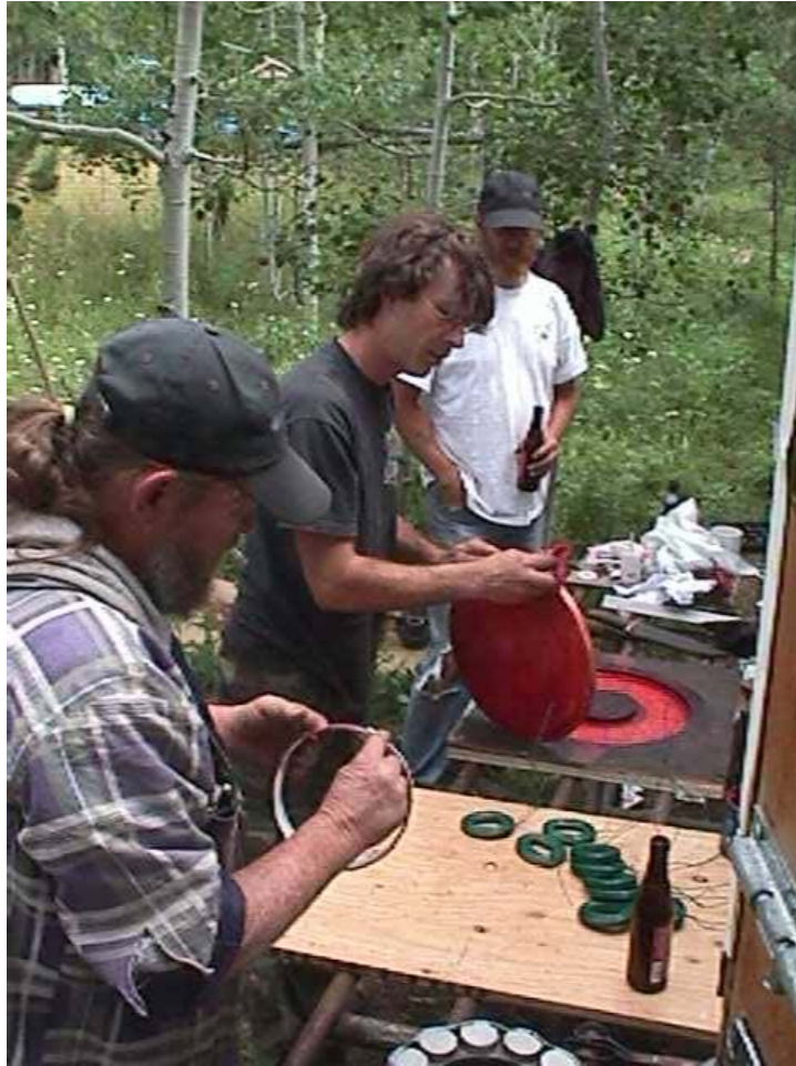
En la fotografía anterior estamos engrasando los moldes.
