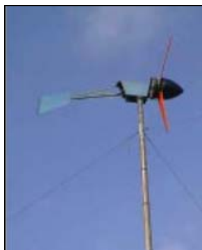
Foto 3.2. Turbina eólica de 1,7 m de diámetro, de 3 palas. [8]
