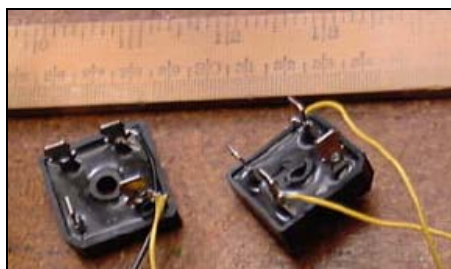
Foto 3.1: Dos rectificadores monofásicos de puente. [6]
