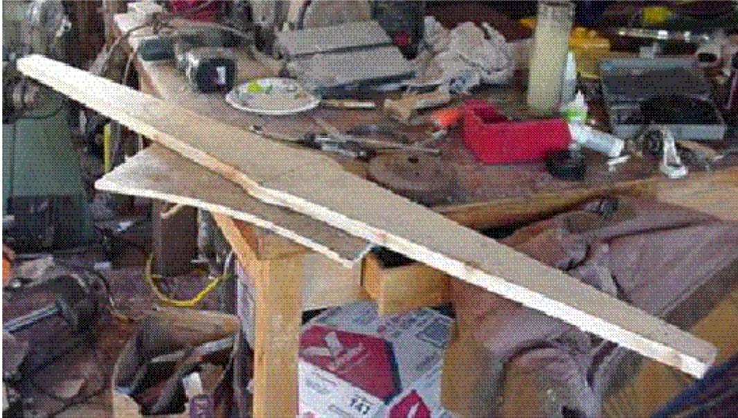
Tienen además un ancho de 2" en sus puntas y 4" en el núcleo, que se ensancha en el centro hasta llegar a 6". La caída en el núcleo será tanta como un trozo de madera de 1" x 4" permitirá.
