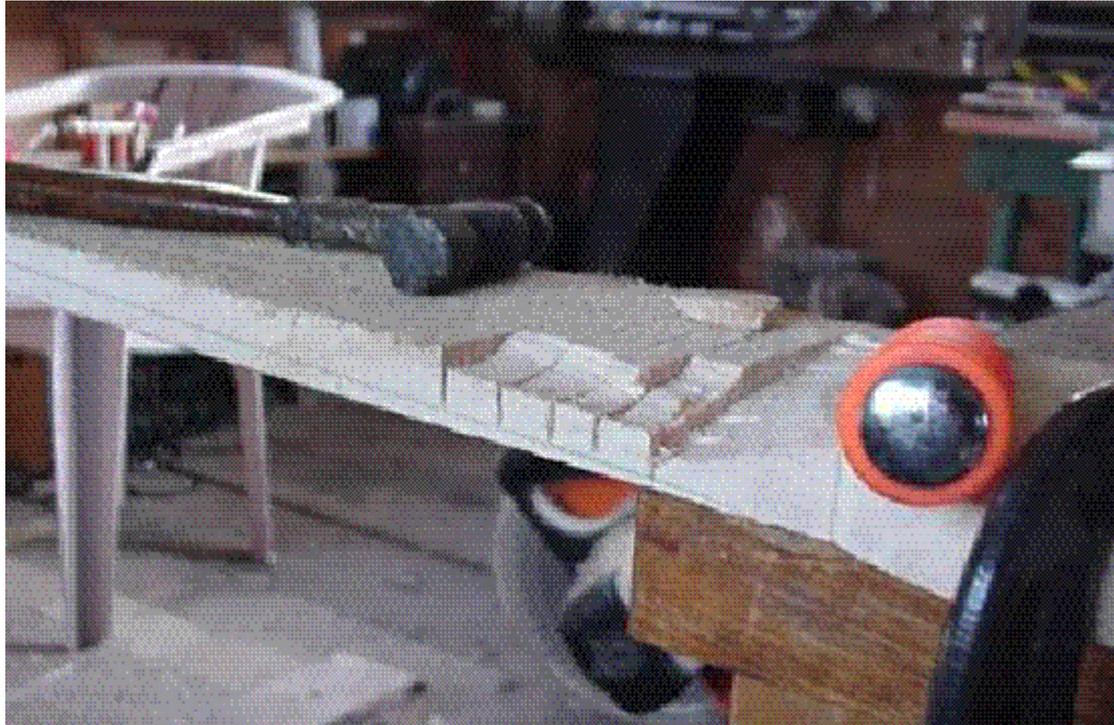
Haga algunos cortes con serrucho en la madera a algo menos de la profundidad que se requiere y empleando un formón la madera se separará fácilmente. Para terminar el trabajo bastarán una escofina y papel de lija. Con dos agujeros en el centro fijaremos este rotor a su sitio.
