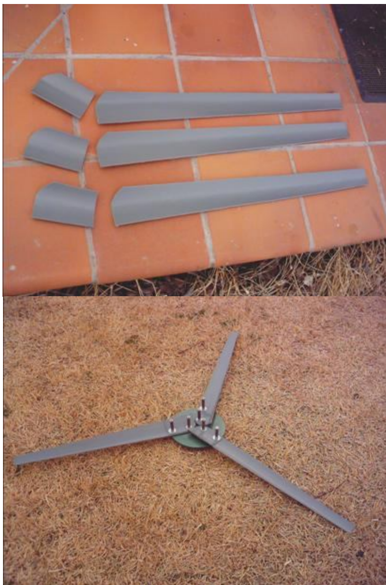
Palas de PVC desmontadas. Las mismas montadas en el rotor del generador.
