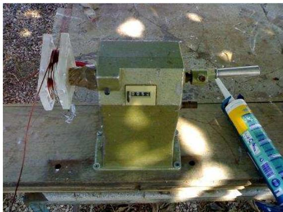
Después de realizar las doce bobinas es conveniente comprobar que “caben” en la plantilla. El grosor de las bobinas se ha mantenido inferior a 15 mm, gracias al pegamento de silicona.
