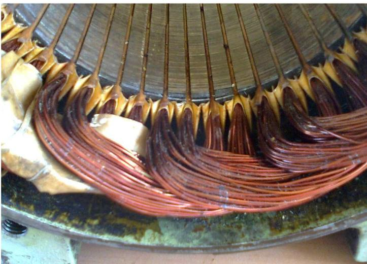
En la foto se puede apreciar un polo del motor formado por dos bobinas. La bobina interior abarca 5 dientes y la bobina exterior abarca 7 dientes
