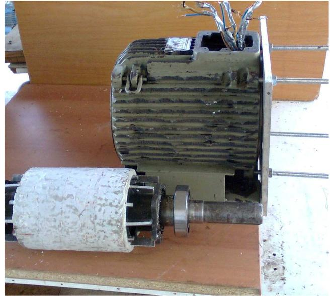
En las fotos siguientes se ve el proceso seguido para introducir el rotor en el estator: primero se coloca el extremo del rotor dentro del estator, y luego se van quitando las tuercas para que la plancha de aluminio se vaya separando del motor y se vaya introduciendo el rotor.
