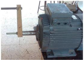
Con la manivela de madera se puede conseguir hacer girar al generador a 60, 120 e incluso 180 rpms. Con la ayuda de un reloj de cocina que marca los segundos, se puede hacer girar el eje del motor a 1, 2 e incluso 3 vueltas por segundo, sin conectar ninguna carga al bobinado, pues en este caso, habría que hacer mucha mas fuerza y no se podría llegar a 180 rpms.
