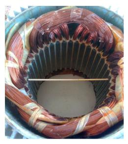
Conseguido esto, se mide la longitud del palillo con una cinta métrica. En última instancia, y como el rotor se debe llevar a un taller de torno, en el propio taller se puede medir el diámetro el rotor, que suele ser 1 mm. inferior al diámetro del estator.
