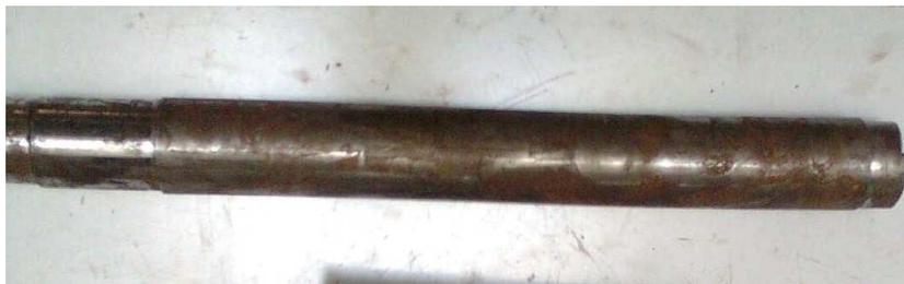
Para construir el nuevo rotor usaremos un tubo de hierro de las medidas adecuadas en longitud y diámetro. La longitud del tubo será ligeramente mayor que la longitud del estator, en este caso 210 mm.
