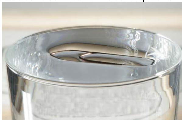
Figura 5.1b Si el clip no ejerce bastante trabajo no se romperá la superficie del agua. El clip es de acero y no está flotando.
