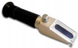
Fig. 8.3 Refractómetro manual. El refractómetro está diseñado para que la luz de una fuente llegue, al menos, en el ángulo límite a un prisma de n_1 conocido. A continuación se sitúa una fina película de una disolución problema ( n_2 desconocido). La luz sale del prisma según las figuras 8.2b y 8.2c e ilumina una escala calibrada en la que se lee directamente el índice de refracción del líquido problema.
