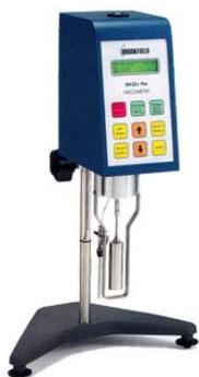
Fig. 4.2 Viscosímetro Brookfield
