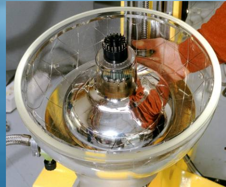
Módulo Óptico: 10" Hamamatsu PMT in 17" esfera de vidrio Detección de fotones
