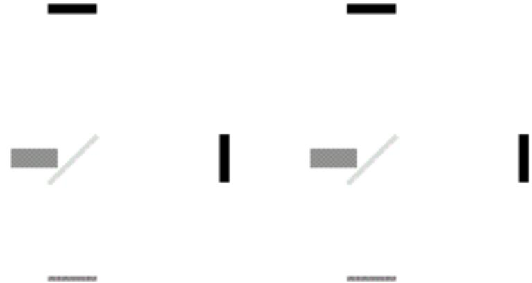
Se analiza el patrón de interferencia cuando los dos haces se recombinan. Si existe el éter, el patrón estará desplazado transversalmente, pues la luz tardará más tiempo en transitar el brazo longitudinal que el transversal.
