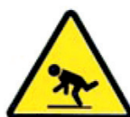
RIESGO DE TROPEZAR
