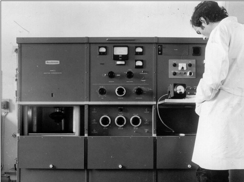
**Figura 1.** Ultracentrífuga analítica en la Escuela Técnica Superior de Ingeniería Industrial de Barcelona.
