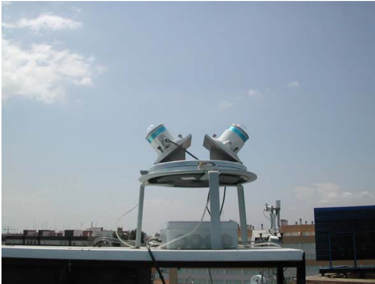
Aparells de mesurament de radiació ultraviolada en el campus de Burjassot-Paterna de la Universitat de València
