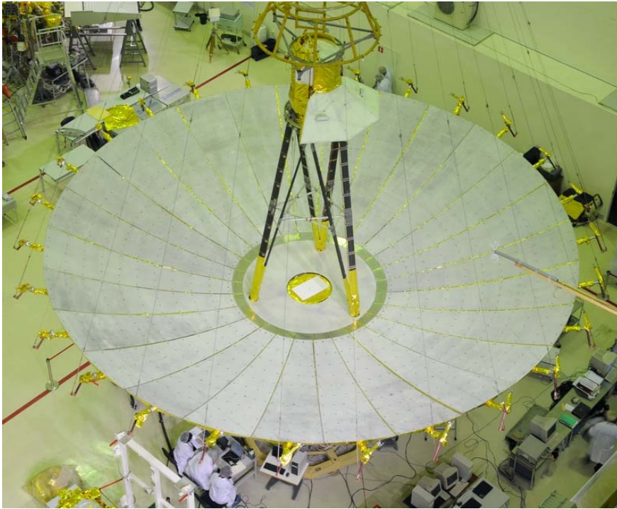
Proves de funcionament de l'antena, de 10 m de diàmetre, a les instal·lacions de l'agència espacial russa, abans que aquest fóra posat en òrbita, el 18 de juliol de 2011.
