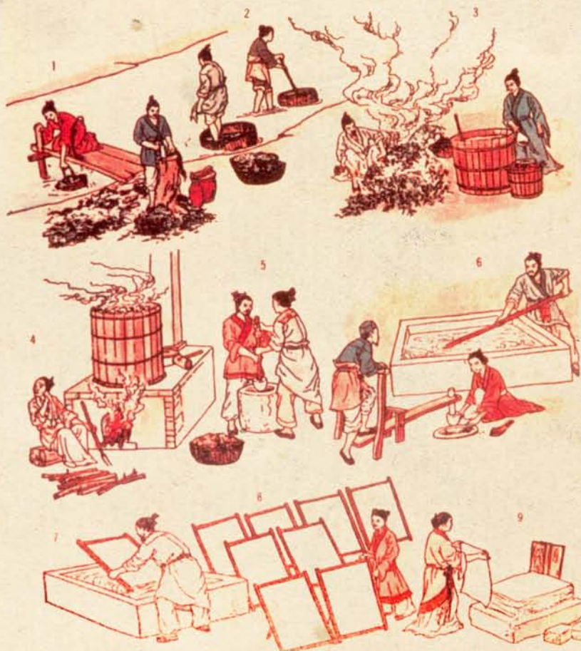
■ 中国古代造纸流程 Proceso tradicional de fabricación del papel.
