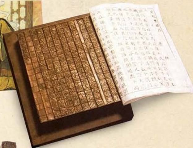
■ El uso de piezas móviles supuso un gran avance al acelerar el proceso de impresión y permitir la reutilización en diferentes composiciones.
