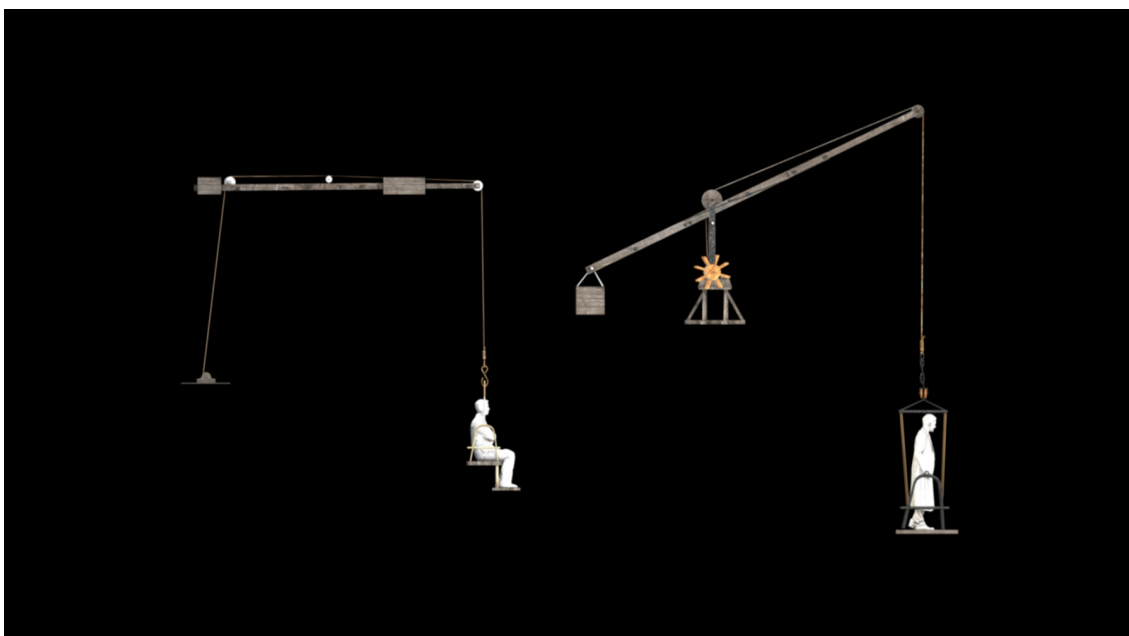
Imagen XLVI. Esquema básico de los elementos constitutivos de la grúa
