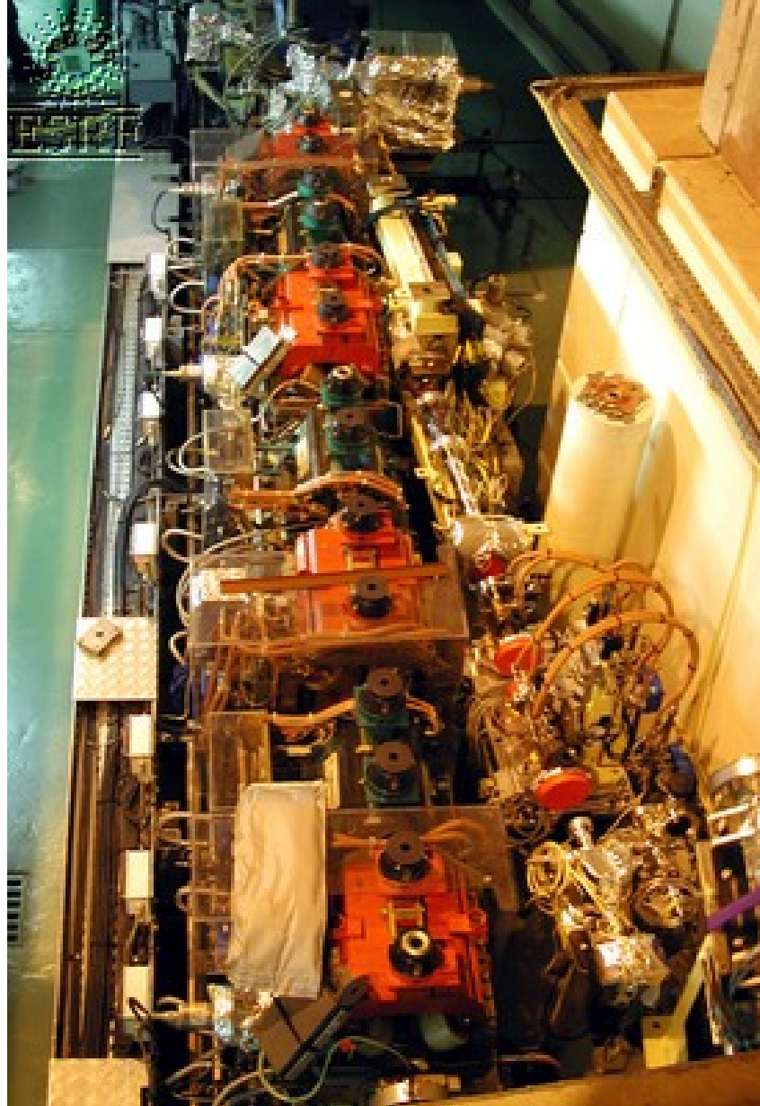
Figura 1.43: Sección del anillo de almacenamiento del ESRF
