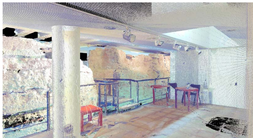
NUBE DE PUNTOS OBTENIDA EN LA TOMA DE DATOS CON ESCÁNER LÁSER
