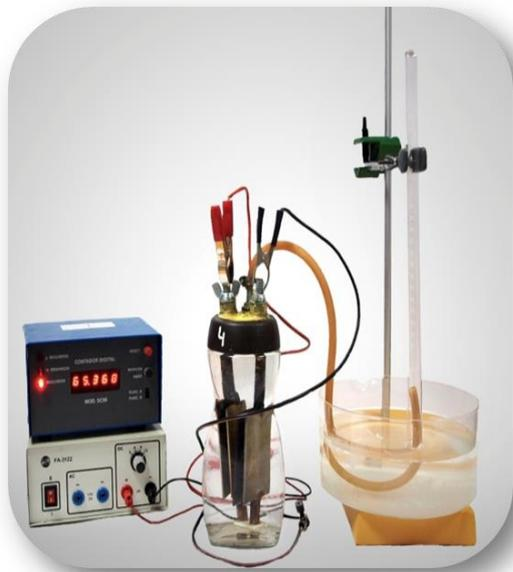
Es muy importante que el generador de gas se encuentre cerrado herméticamente ya que así se evita la fuga de gases. En la cubierta del recipiente habrá un orificio por donde saldrá el gas a través de un tubo de goma que lo dirigirá hacia el tubo de recogida de gases de la cuba neumática.
