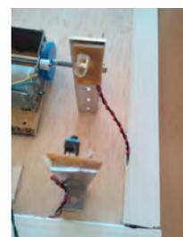
Sensor de infrarrojos (IR). Es un dispositivo electrónico capaz de medir la radiación electromagnética infrarroja de los cuerpos en su campo de visión. Todos los cuerpos, en función de su temperatura, emiten una cierta cantidad de radiación, esta resulta invisible para nuestros ojos pero no para estos aparatos electrónicos, ya que se encuentran en el rango del espectro justo por debajo de la luz visible.
