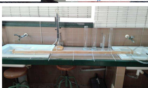
Fotos 6 y 7: Determinación de la pérdida de energía mecánica
