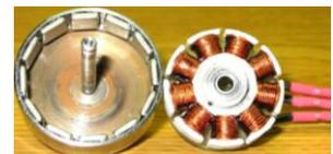
La corriente proporcionada es continua proveniente de una batería LiPo ( Polímero de litio), ya que estos motores necesitan un alto potencial eléctrico, 11.1V, e intensidad 30A aprox. Los imanes permanentes del rotor se ven atraídos por los polos del estator gracias a la conmutación que hacen los ESC (controladores electrónicos de velocidad) que por medio de unos sensores, saben cuándo aplicar corriente a qué par de bobinas y así producir la rotación.
