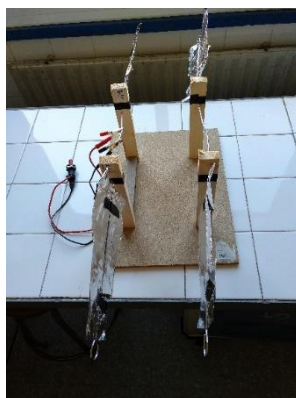
Figura 3: Montaje para producción y detección de ondas electromagnéticas
