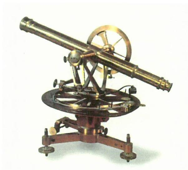
Figura 3. Teodolito topográfico, instrumento para medir ángulos adquirido en 1907.
