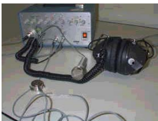
Figura 9. Suvag II con micrófono, auriculares y vibrador.
