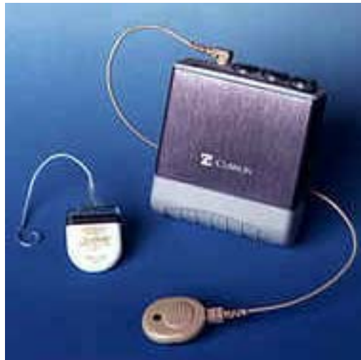
Figura 4. Componentes del implante coclear
