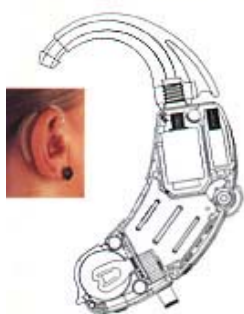
Figura 1. Imagen transversal de un audífono retroauricular
