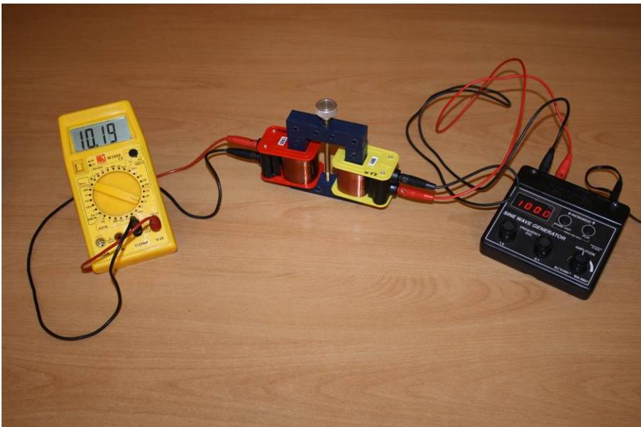
**Figura 3:** Transformador eléctrico y componentes para caracterizarlo.
