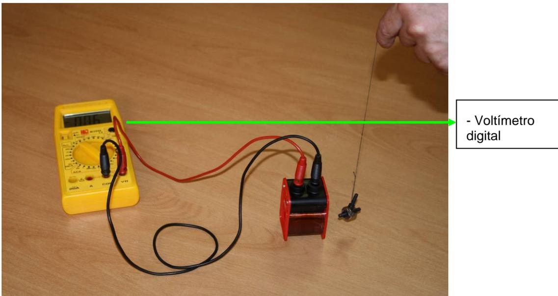
**Figura 1 (d):** Dispositivo para generación y medida de tensión alterna.
