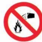
PROHIBIDO APAGAR CON AGUA
