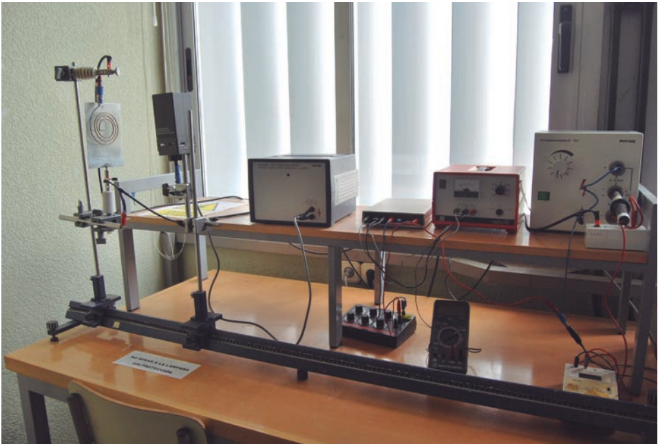
DETERMINACIÓN EXPERIMENTAL DE LA INTENSIDAD DE CORRIENTE FOTOELÉCTRICA EN UNA CÁMARA DE ONIZACIÓN ABIERTA (2008-09)
