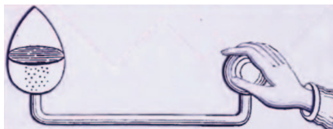
Fig. 2. El “Franklin’s pulse glass” se usaba en el siglo XIX para demostrar la variación de la temperatura de ebullición con la presión. El frasco se sella mientras el líquido está a su temperatura de vaporización normal. Al enfriarse, el sistema queda en equilibrio líquido-vapor a presión inferior a la atmosférica. Tocando uno de los dos bulbos con la mano, el aumento de temperatura provoca un desplazamiento de este equilibrio, aumentando la cantidad de sustancia en fase vapor y observándose un burbujeo [2].
