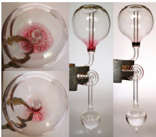
Fig. 6. Manteniendo el frasco invertido a temperatura ambiente, desde una situación inicial con el disolvente líquido puro en el recipiente inferior B y tinte sólido en el superior A (último panel de la Figura 5), se observa que las partículas sólidas de tinte actúan como núcleos de condensación del vapor de disolvente (panel izquierdo). El volumen de la disolución que se va formando en A aumenta muy lentamente. El panel central corresponde a un día de experiencia y el panel derecho a dos semanas. El disolvente puro tiene más presión de vapor (más tendencia a evaporarse) que la disolución (ley de Raoult) y, por ello, no puede haber equilibrio de distribución. El disolvente fluye desde el líquido puro en B (fase donde su potencial químico es mayor) a la disolución en A (donde su potencial químico es menor) a través de la fase gaseosa que los conecta (donde es intermedio).
