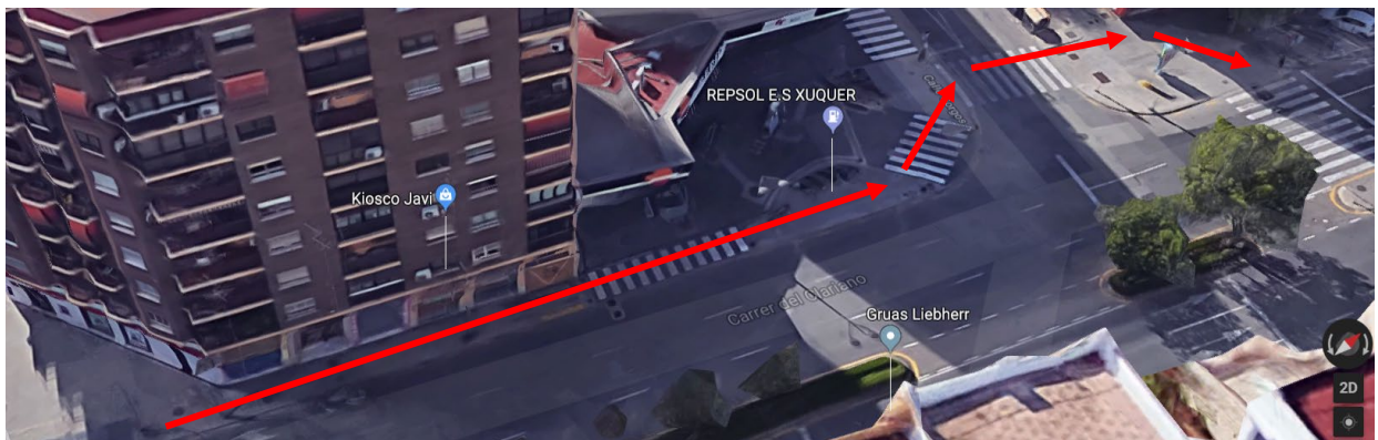
Recorregut continu per a vianants per la vorera del c. Clariano. La vorera és estreta en aquest tram. Disposa de rebaixos i paviment senyalitzador en els passos de vianants.
