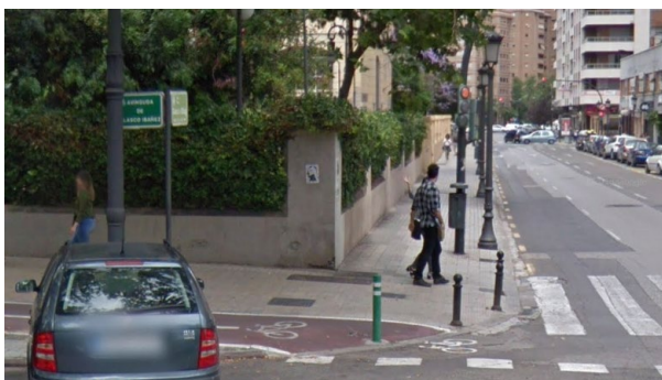
Vorera de l'avinguda amb el c. Gascó Oliag: estreta amb presència d'obstacles (semàfor, fanals)
