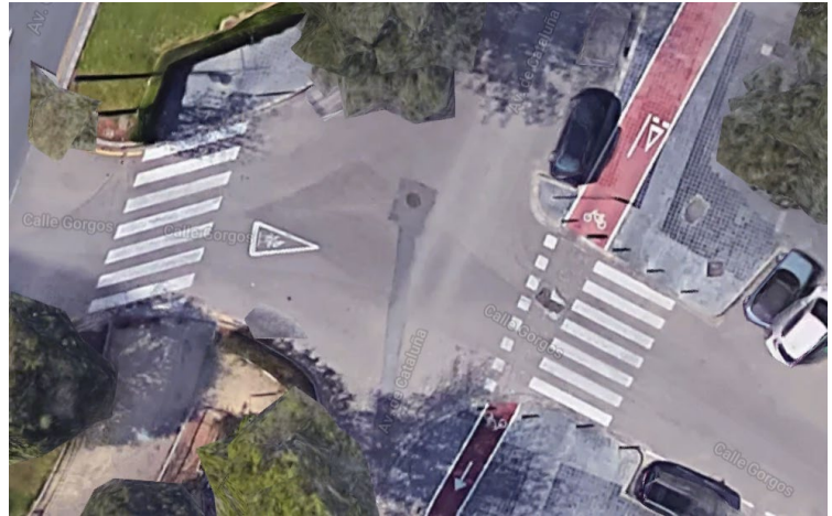
Passos de vianants que donen continuïtat a l'itinerari per a vianants de la zona enjardinada i la vorera, en l'encreuament que té amb el c. Gorgos, amb rebaixos i paviment senyalitzador
