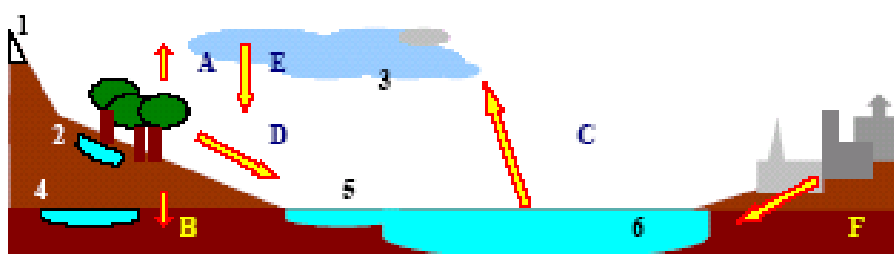
Figura 2: Ciclo del agua. Tipos de agua: (1) hielo, (2) agua edáfica, (3) agua atmosférica, (4) agua subterránea, (5) agua superficial y (6) agua salada. Procesos: (A) transpiración, (B) percolación, (C) evaporación, (D) escorrentía, (E) precipitación y (F) contaminación.
