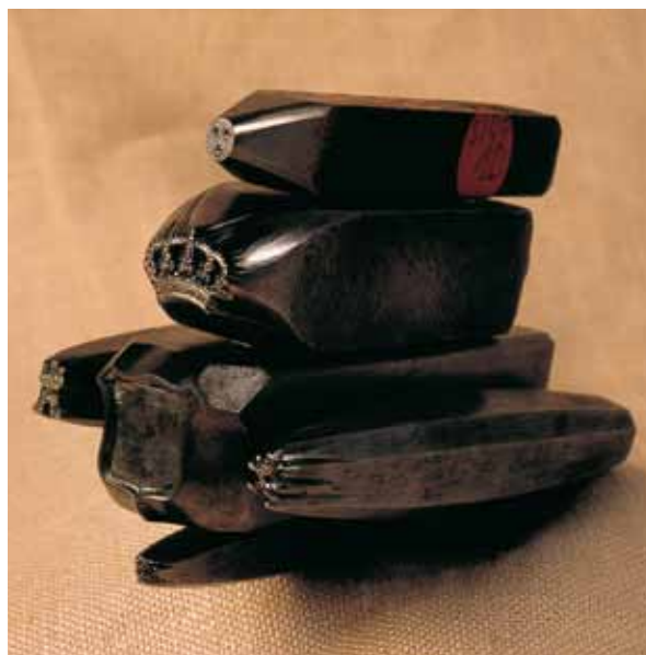
Punzones para el diseño de un escudo (FMNT). Mediante la utilización de punzones, los grabadores lograban ahorrar un tiempo considerable en la fabricación de los cuños.
