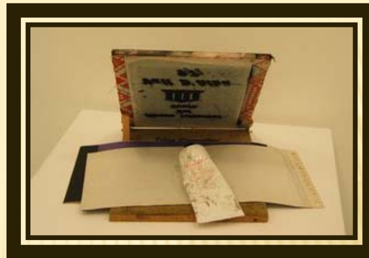
Multicopista "vietnamita" per fer còpies amb clitxes i tinta. Realitzada amb fusta. Càtedra Enric Soler i Godes
