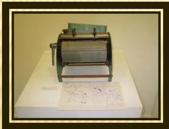
Màquina d'alcohol utilitzada com multicopista. Requereix la utilització d'un clixe amb el text a imprimir. Càtedra Enric Soler i Godes
