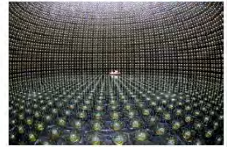
Interior del tanque del Super-Kamiokande, con sus paredes forradas por miles de detectores de luz. Gracias al efecto Cherenkov, los neutrinos producen un determinado tipo de luz al interactuar con el agua pesada, lo que permite identificarlos. t2k/ific
