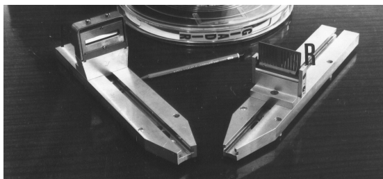
Figura 2.2: Detector de estado sólido sensibles a la posición (izquierda) y rejilla (derecha) para el calibrado angular.
