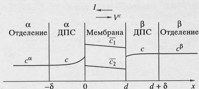
Рис. 2. Схема мембранной системы; показаны профили концентраций.
