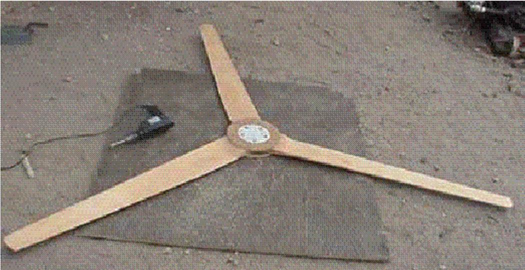
Es de tres aspas y de 96” de diámetro. La caída en la punta es de aproximadamente 4 grados. En el eje aproximadamente 8. En el eje cada aspa es de 7” de ancho y en la punta de 3 1/2”. Además tienen un espesor de 7/8” en el eje y de 5/8 en la punta. En su lugar más ancho el espesor es aproximadamente 35% de la longitud del plano.
