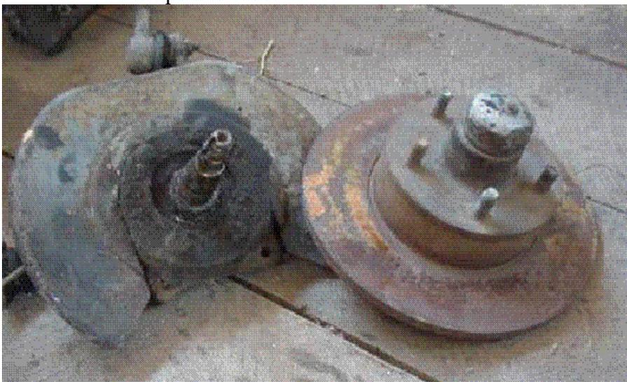
El único trabajo de taller que se requiere es tallar una canal de 1 ½” en la superficie del disco de freno dejando un borde exterior de 1/16”. En ésta canal se insertarán los imanes impidiendo que escapen de su sitio cuando el rotor gire a altas velocidades. No confíe en los “pegamentos de acero”.
