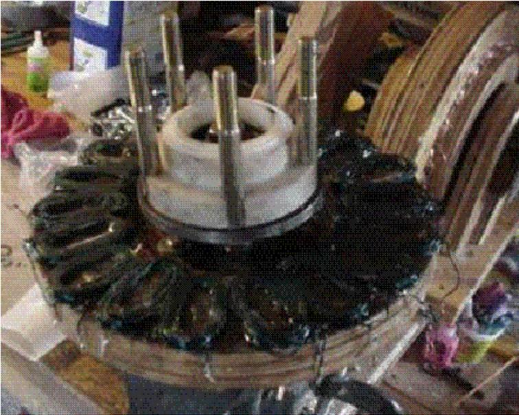
Aquí tenemos el alternador listo. Temporalmente todas las bobinas están en serie y nos proporciona 15 voltios a un simple giro por mano. El próximo paso es fijarlo a un taladro cuyas velocidades sean conocidas, como en el caso del generador anterior y por medio de instrumentos determinar su velocidad y generación más eficiente (En serie o paralelo).
