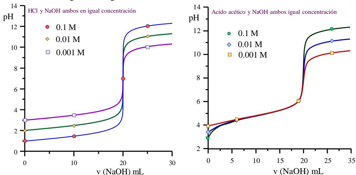
En la figura siguiente se muestra el efecto del  $pK_a$  en la valoración de distintos ácidos 0.1 M con NaOH de igual concentración:
