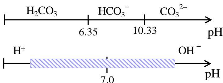
Así, en el sistema carbonato/ácido carbónico son compatibles las mezclas  $\text{OH}^-/\text{CO}_3^{2-}$ ;  $\text{CO}_3^{2-}/\text{HCO}_3^-$  y  $\text{HCO}_3^-/\text{H}_2\text{CO}_3$ . En este sistema el ácido
