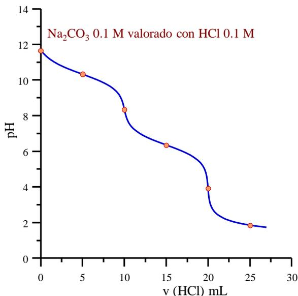
El primer salto se encuentra acotado por dos disoluciones amortiguadoras y para que pueda ser útil, como se verá posteriormente, debería cumplirse que:
