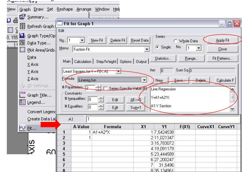
Se pueden hacer varios ajustes sobre la misma gráfica. Si deseas crear uno nuevo, pincha en “New Fit”. Para cambiar entre un ajuste y otro, cambiar el número de “No.”. Si deseas eliminar un ajuste, selecciona el número correspondiente y pincha en “Delete Fit”.
