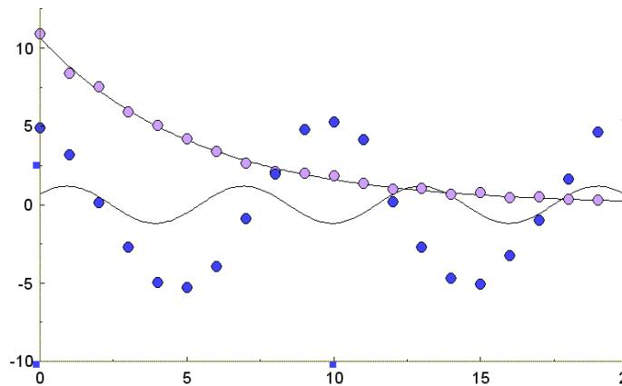
Tendremos que modificar los valores iniciales del ajuste, podemos estimar fácilmente la amplitud de la función sinusoidal, aproximadamente debe valer  $A1=5$ . Repetimos el ajuste eliminando el parámetro  $A1$  para obtener así el valor aproximado de los otros dos. La ecuación a ajustar quedaría:  $F(X)= 5*\cos(A1*X+A2)$ . Debemos eliminar la inequación sobrante y readjustar el número de parámetros.
