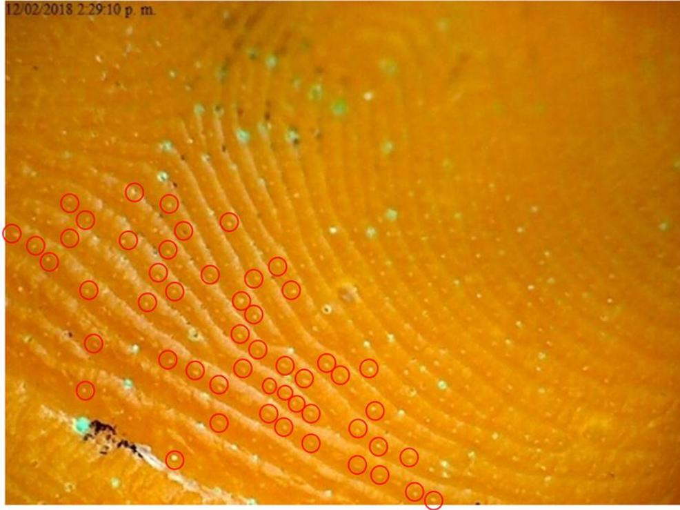
**Ilustración 4: Huella moldeada con copiado de poros (Microfotografía)**
