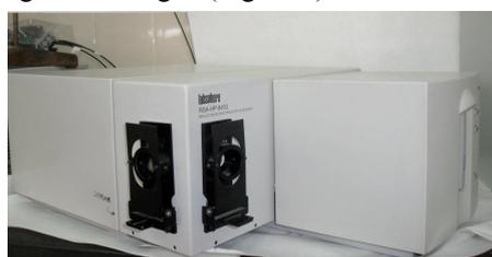
Figura 6.- Espectrofotómetro de Reflectancia Difusa HP-8453
