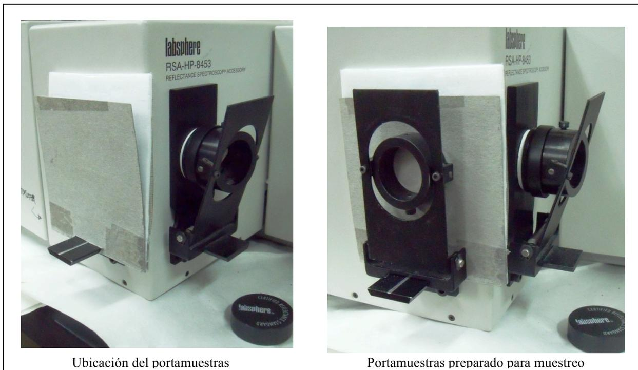
Figura 11.- Disposición del portamuestras en el Equipo.
