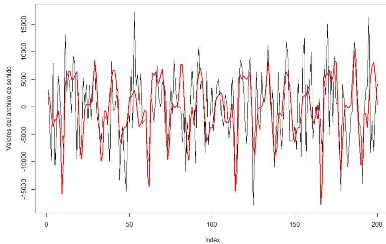
**Figura 1:** Onda sonora facilitada a los/as alumnos/as (con ruido), línea negra, y onda original (sin ruido), línea roja, que ha de ser reconstruída.
