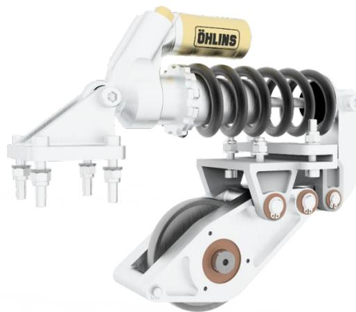
**Figura 1:** Sistema de control vertical. (Fuente: Hyperloop UPV)
