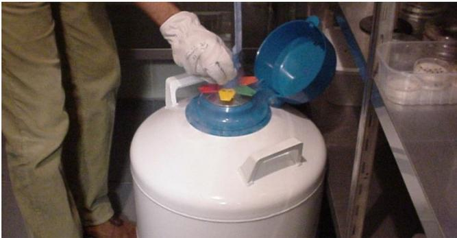
Extracción de muestras de un pequeño tanque de nitrógeno líquido en el Banco de Germoplasma del Jardín Botánico de la Universidad de Valencia.
