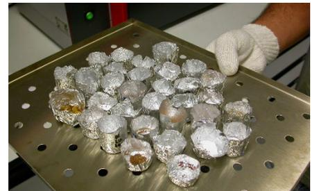
Semillas preparadas para introducirlas en la estufa para aplicación de calor seco.
