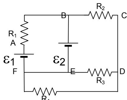
2.5.- Resolver el circuito de la figura y determinar el equivalente Thevenin del circuito (entre A y B). Si conectamos entre A y B una resistencia de 1000  $\Omega$ , ¿qué intensidad de corriente circulará por ella?.
