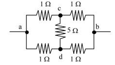
**14.4.-** Calcula las corrientes  $I_1$ ,  $I_2$  e  $I_3$  en el circuito de la figura, así como la diferencia de potencial entre b y c.
