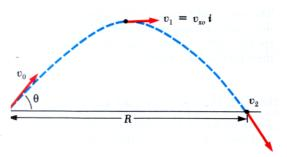
$$SOL.: \ a) \ \vec{L}_0 = \vec{0} \ ; \ b) \ \vec{L}_1 = -\frac{m v_0^3 \cos \theta sen^2 \theta}{2g} \vec{k} \ ; \ c) \ \vec{L}_2 = -\frac{2 m v_0^3 \cos \theta sen^2 \theta}{g} \vec{k} \ ; \ d) \ el$$
