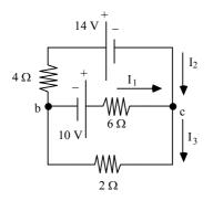
**14.5.-** En el circuito de la figura, calcula la corriente que pasa por cada una de las ramas, así como las diferencias de potencial  $V_a$ - $V_b$ ,  $V_b$ - $V_d$  y  $V_d$ - $V_e$ . Comprobar que la potencia suministrada por los generadores es igual a la consumida por las resistencias.
