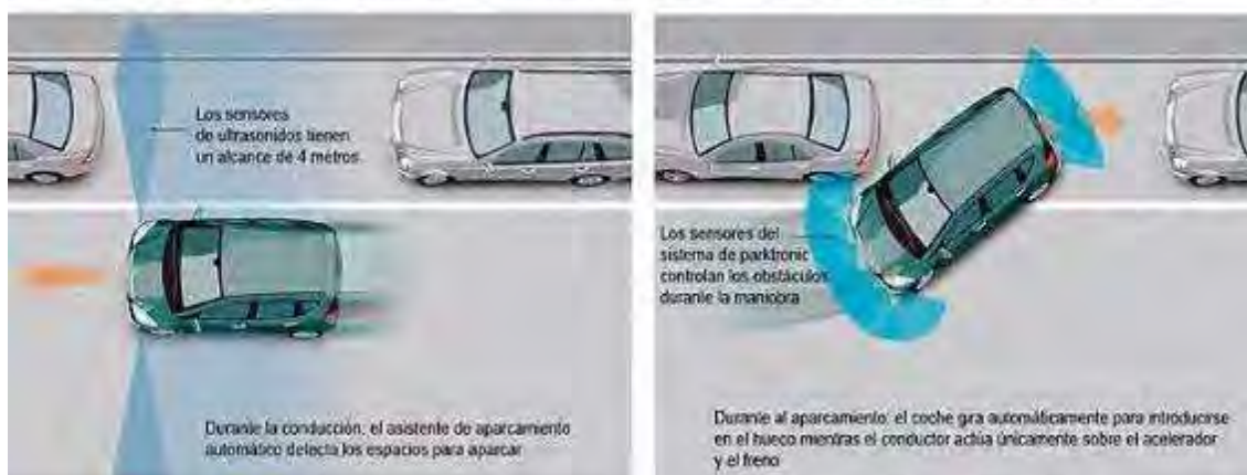
Asistente de aparcamiento automático: con sensores de ultrasonidos y dirección electromecánica
