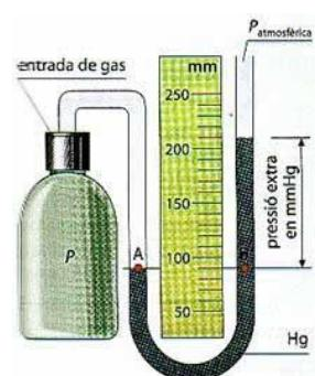
La presión extra, sobre la atmosférica, es debida a la diferencia de altura en milímetros de mercurio. Si la diferencia de altura es de 8 cmHg = 80 mmHg, entonces:
