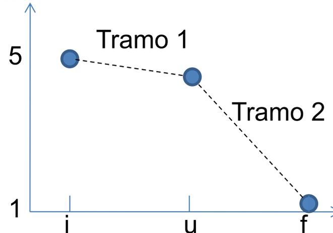
El flujo se iguala porque la caída de presión se reparte de manera desigual entre los 2 tramos. El flujo lo podemos calcular usando cualquiera de los tramos:
