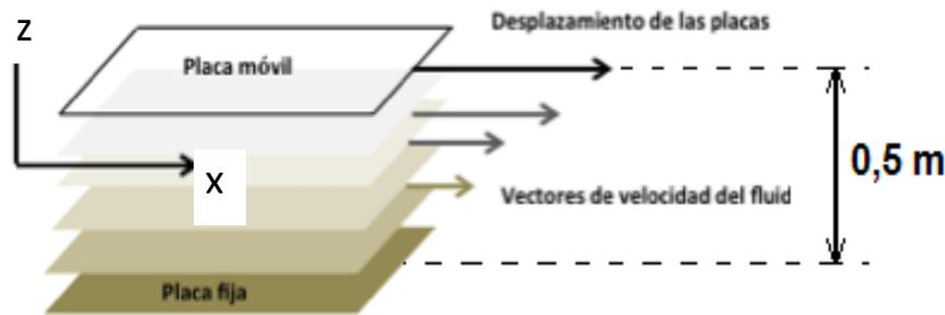
La componente del gradiente de velocidad (en régimen estacionario) tiene un valor medio de
